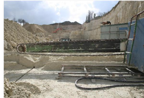
Une partie des rebuts de sciage, appelés stériles, sera valorisé (fines de découpes, blocs de pierres cassés ou altérés valorisés en moellons...), de même qu'une partie de la découverte.
